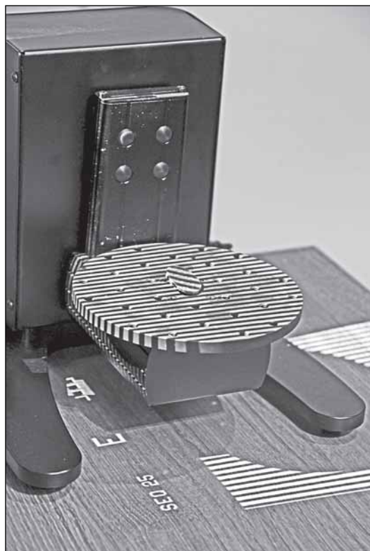
Монета на рабочем столике ювелирного сканера
